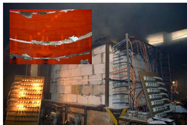
Рис. 1. Внешний вид испытательной печи и контрольно-измерительного оборудования во время испытания.
