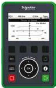
Выносной графический терминал (пример отображения скорости и момента в динамике)
