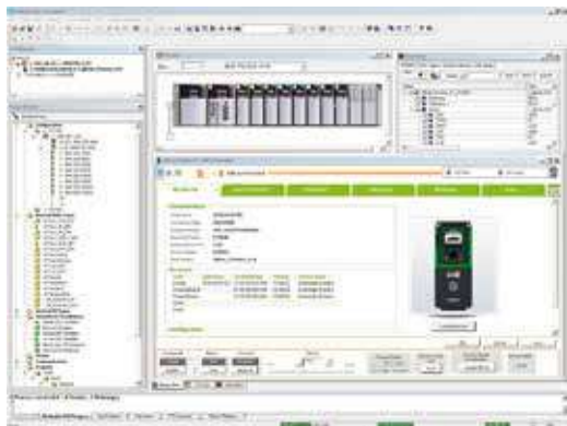
Использование библиотек DTM для преобразователей частоты Altivar Process в среде конфигурирования Unity Pro
