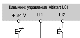
Схема 3-проводного управления
