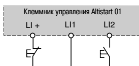
Схема 3-проводного управления
