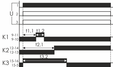
Режим F3. «Формирование импульса по K1. Задержка включения по K2. Задержка выключения по K3»
