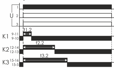
Режим F5. «Задержка выключения по K1...K3»
