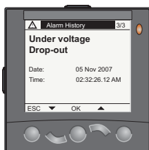
Сигнал о неполнофазном режиме
