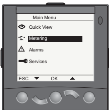
Дисплей щитового индикатора FDM121: перемещение по меню
